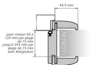
pour cloison 50 à 124 mm par plage de 15 mm jusqu'à 393 mm par plage de 15 mm avec élargisseurs
