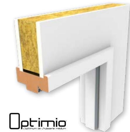
Huisserie en MDF hydrofuge enrobage papier blanc (protégé par un film transparent) pouvant être peint disponible en 5 sections (monobloc jusqu'à 90 mm) largeur 45 mm
