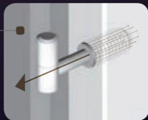
Ce système permet de déboîter le vantail de l' huisserie et d'augmenter le jeu au niveau de la rotation du vantail, endroit très sensible où les efforts résiduels sont particulièrement démultipliés. Le réarmement du vantail s'opère automatiquement après un cycle d'ouverture - fermeture. Un système simple, efficace et sécurisant.
