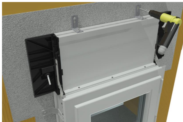
Fixation de la patte lors d'une mise en œuvre sous dalle
