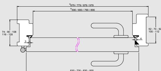
\*Largeur - 7 mm dans le cas d'un bloc-porte isolant avec une crémone.
